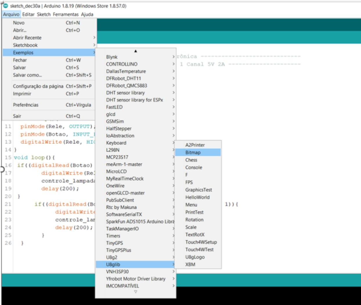
Com o código aberto, clique em Ctrl+f para abrir a janela localizar. Em localizar digite o nome do controlador do seu display. Olhando o datasheet do display utilizado para teste, vimos que o controlador é o KS0108.
