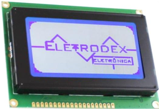
O Display LCD Gráfico L1-12864A-AZ 128x64 é um excelente display voltado para implementações gráficas, que necessitam de uma exibição personalizada com maior riqueza de detalhes, possibilitando desde a exibição dos simples caracteres alfanuméricos, até a exibição de imagens em estilo monocromático.
