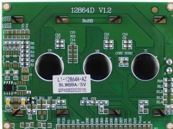
Os **pinos 1 e 2** são referentes a alimentação do Display, sendo o pino 1 VSS Zero Volts (GND), e o pino 2 VDD, o pino de alimentação positiva de 3.3 à 5V;
